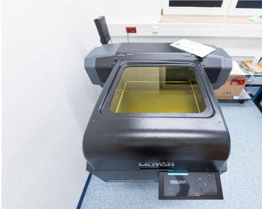
Abbildung 8 Der neue UV-Drucker im Zentrum für Barrierefreiheit. Der Drucker ist etwa so groß wie ein Konzertflügel. Vorne rechts befindet sich ein Touchdisplay zur Bedienung. Die zu bedruckenden Materialien werden auf dem beweglichen Druckbett positioniert, welches sich unter einer großen Schutzklappe befindet.
